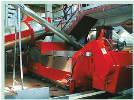
Fig. 71: Sistema de presión del orujo de vino tinto
