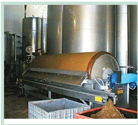
Fig. 45: Filtro-Prensa de mosto de uva y filtro de rotación de vacío con celulosa, tierra de diatomeas o perlita
