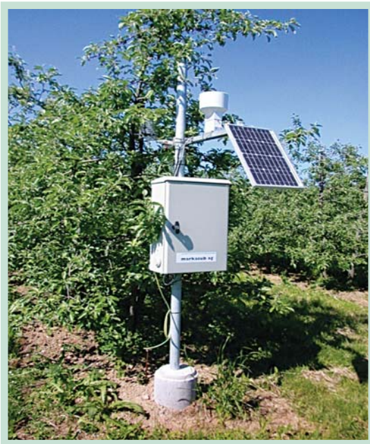
Fig. 20: Una estación meteorológica “LUFFT” que puede ser usado para modelar la presión del ataque de enfermedades fúngicas. 5
