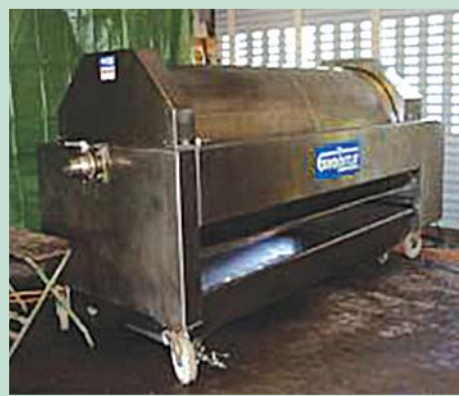
Fig. 40: Prensa de tornillo vertical interna
