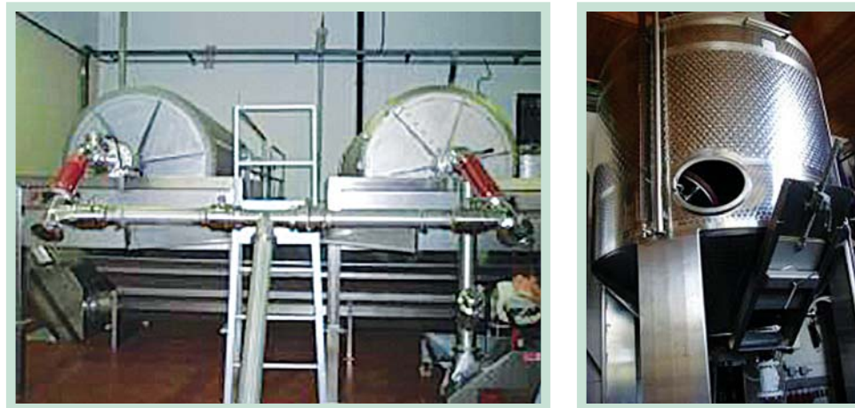
Fig. 69: Tanques de maceración de vino tinto: Fermentadores de taza de acero inoxidable
