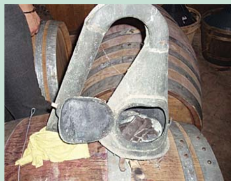
Fig. 75: Medidas tradicionales para conservar los barriles quemando cintas de sulfuroso.
