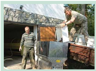
Fig. 38: Moderno despallidor y estrujador para uvas blancas y tinta (bodegas grandes y pequeñas).
