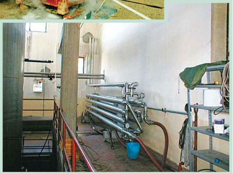
Fig. 65: Equipamiento técnico para el enfriamiento y calentamiento – intercambiador de calor tubular. (Röhrenwärmetauscher; Echangeur de température tubulaire).
