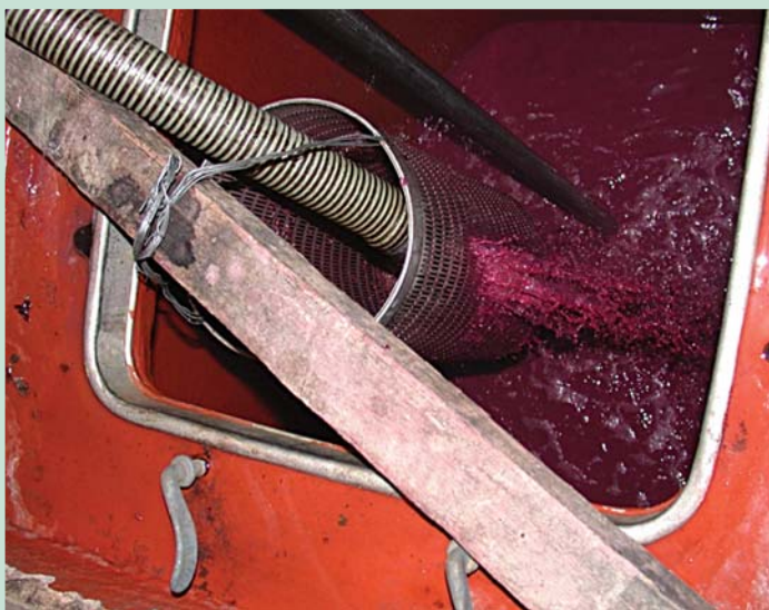
Fig. 68: Ilustración del bombeo de remontada (“remontage”) con aireación.
