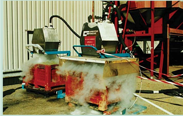
Fig. 64: Equipamiento técnico para el remojado frío con hielo seco. Producción de nieve carbónica.
