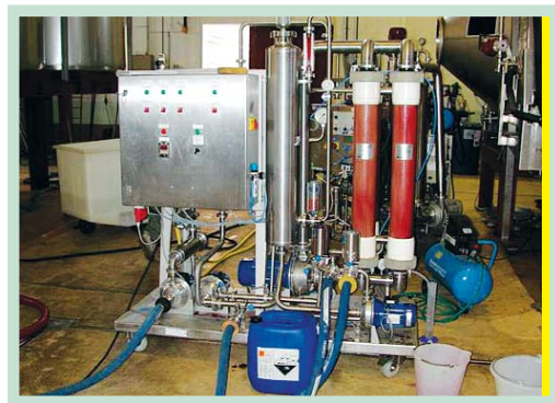
Fig. 78: Filtro de membrana para filtración estéril
