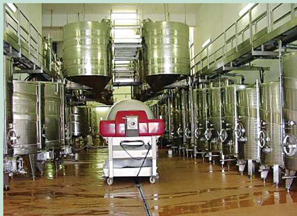
Fig. 62: Tanques de fermentación de vino tinto elevados, para llenar sin bombeo, los recipientes de prensado horizontales.
