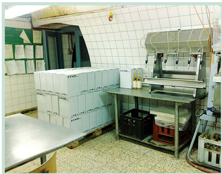
Fig. 78: Embotelladora para una bodega familiar
