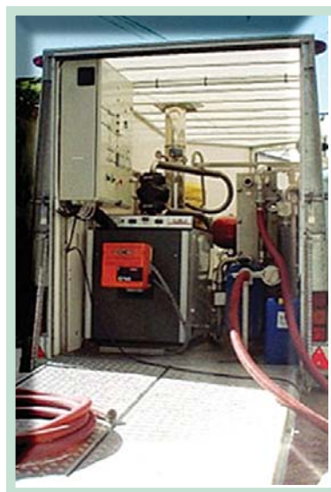
Fig.94: Equipamiento técnico para la pasteurización instantánea
