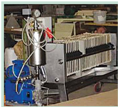
Fig. 45: Filtro-Prensa de mosto de uva y filtro de rotación de vacío con celulosa, tierra de diatomeas o perlita
